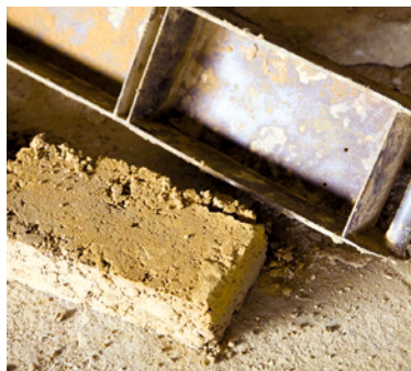
▲ Formung im Handschlagverfahren.
