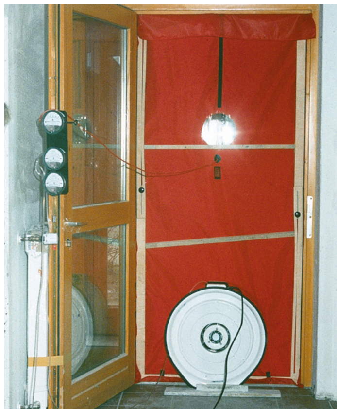
Foto 3: Messapparatur zur Überprüfung der Luftdurchlässigkeit: Messuhren, eingebauter Spannrahmen mit Folie und Ventilator.
