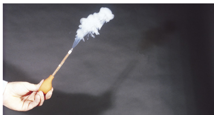
Foto 5: Aufgesägtes Glasröhrchen; durch Drücken auf den Gummiball wird Rauch freigesetzt.
