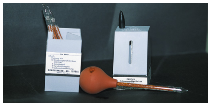
Foto 4: Strömungsprüfer für Luft zum Sichtbarmachen von Luftströmungen bei Undichtheiten, Strömungsprüfröhrchen-Set.
