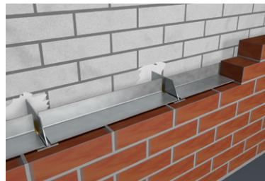
▲ EK-M Für nachträgliche Verankerung im Verblendmauerwerk Laststufen: 3,5 kN–7,0 kN, Wandabstände: 20 mm–200 mm
