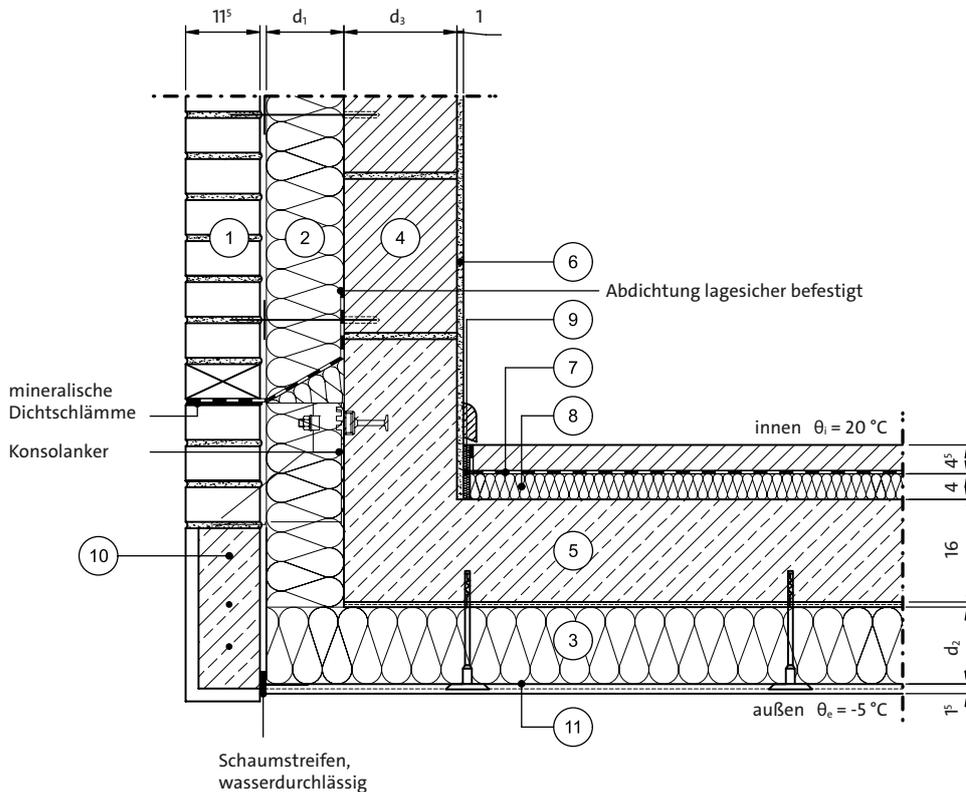
Es muss sichergestellt sein, dass Wasser, das rückseitig an der Verblendung abläuft, abgeführt wird.
